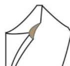
外圆刃尖破损 Corner fracture
