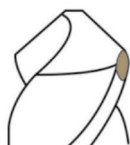
外圆刃尖破损 Corner fracture
