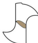
横刃边破损 Chisel edge fracture
